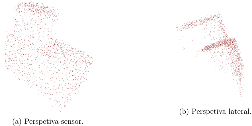
Figura 4.21: Nuvens de pontos parciais resultantes do virtual_scanner modificado, com inclusão de ruído.
