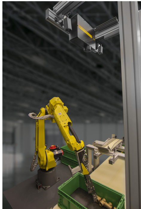
Figura 2.9: Figura ilustrativa da solução fornecida pela Fanuc, com o manipulador e sensor da marca [15].
